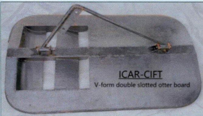
वाणिज्यिक ट्रालर में V आकार के दोहरे स्लोटवाले ओटर बोर्ड V-form double slotted otter board
