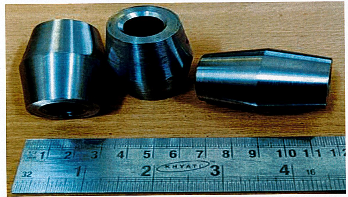
चित्र 5 तल ट्रॉल्स के लिए बनाए गए स्टेनलेस स्टील निमज्जक के प्रोटोटाइप
