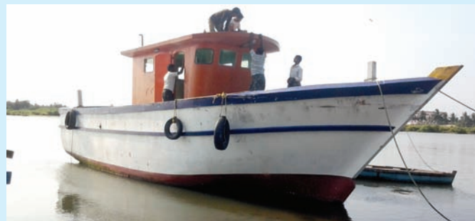
अंडमान एवं निकोबर द्वीप के लिए 13.7 मी L_{OA} एफ आर पी ट्यूना मत्स्यन यान कुडल्लूर में स्थिरता परीक्षण के लिए तैयार
